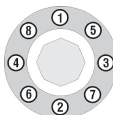
Инструкция по затяжке гаек
